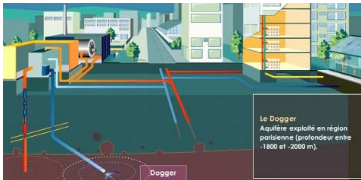
Photo : ADEME Principe de la géothermie
